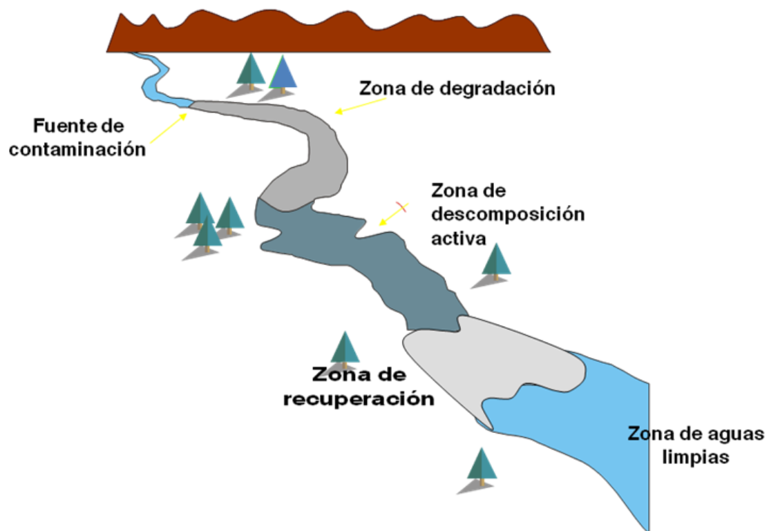
Figura 7. Ilustración de las zonas de un río por el vertido de líquidos cloacales.
