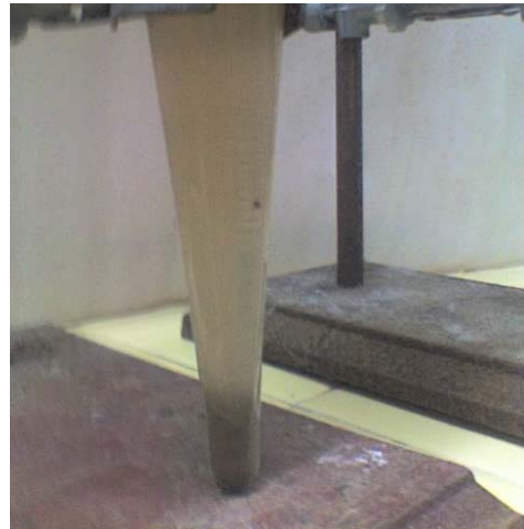
Figura 3. Sólidos sedimentados en conos Imhoff a las 2,5h de iniciado. Río Bermejo (Mendez, 2008)
