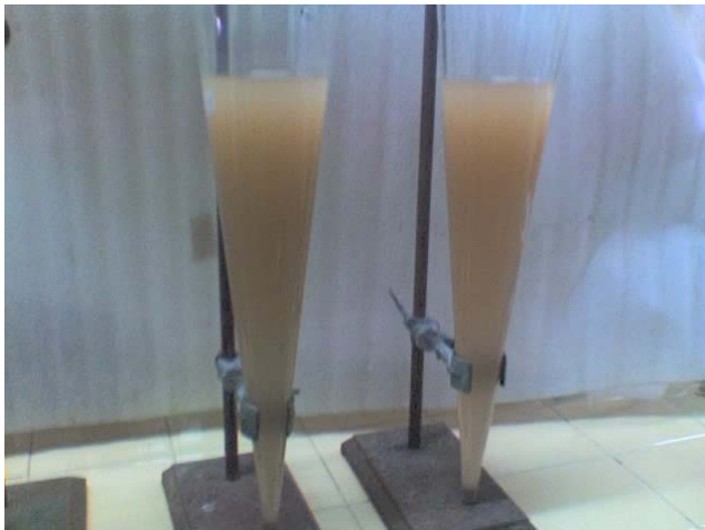
Figura 2. Ensayo de sedimentación con conos Imhoff a las 2,5h de iniciado. Río Bermejo (Mendez, 2008)
